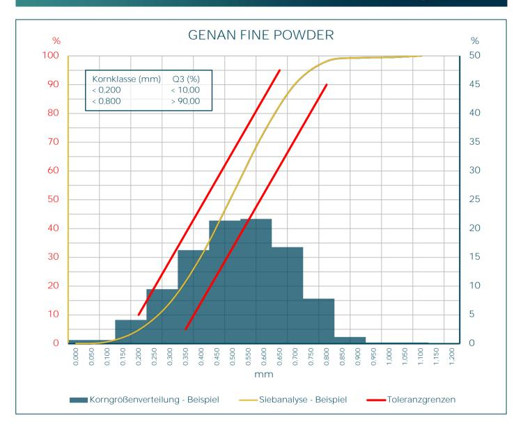
Die Siebanalyse des Materials wird mit einem CAMSIZER der Firma Retsch Technology durchgeführt.
